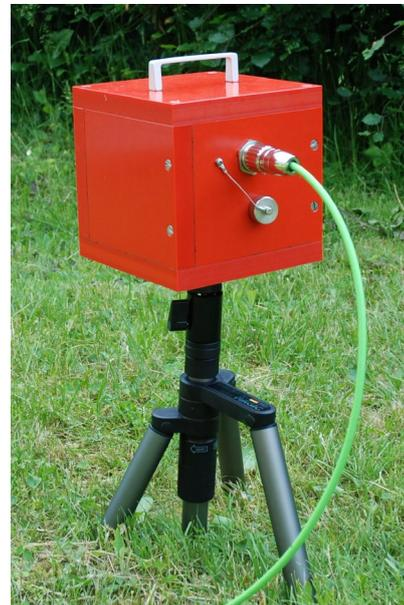
1台の SHFT-02e で直交する3軸の磁場変動を測定することが可能です。センサーや電気回路は高耐衝撃性のケースに収納されています。SHFT-02e は metronix 社のデータロガー ADU-07e (メインシステムユニット) やその他特注の回路と接続可能です。
